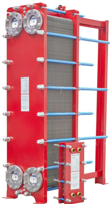
**Назначение.** Пластинчатый теплообменник – устройство для передачи тепловой энергии от более нагретой среды к менее нагретой через тонкие металлические гофрированные пластины. Пластины, стянутые в пакет, образуют каналы, где протекают рабочие среды, между которыми происходит обмен тепловой энергией.
