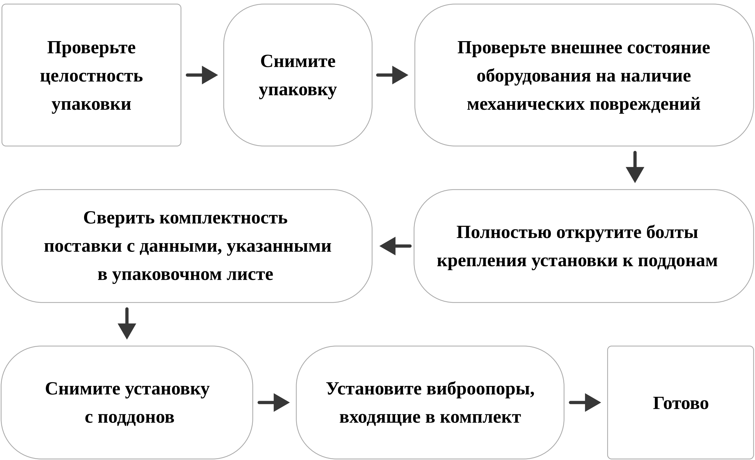
Рисунок – 9. Блок-схема последовательность действий при распаковке НУ
